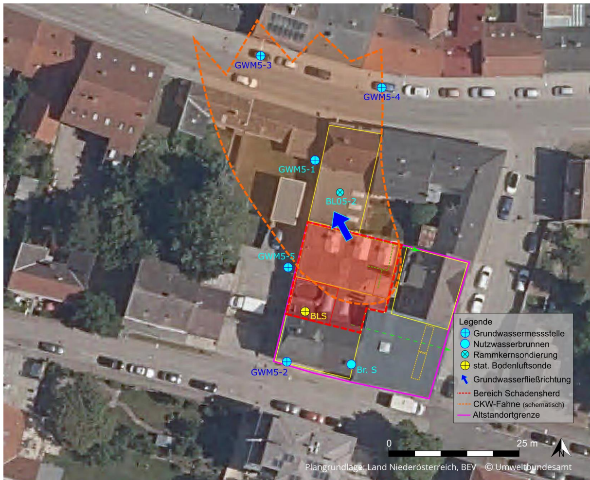
Abb. 9: Bereich Schadensherd und CKW-Fahne
