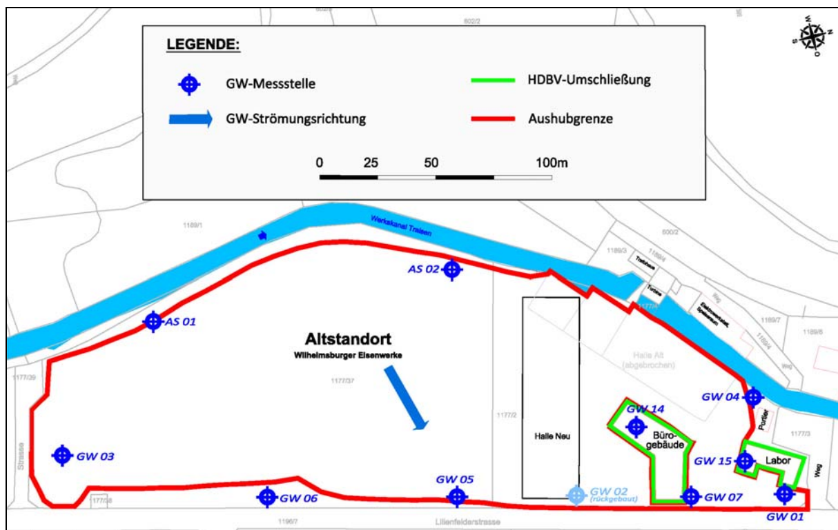
Abb.3: Durchgeführte Sanierungsmaßnahmen und Lage der Grundwassermessstellen
