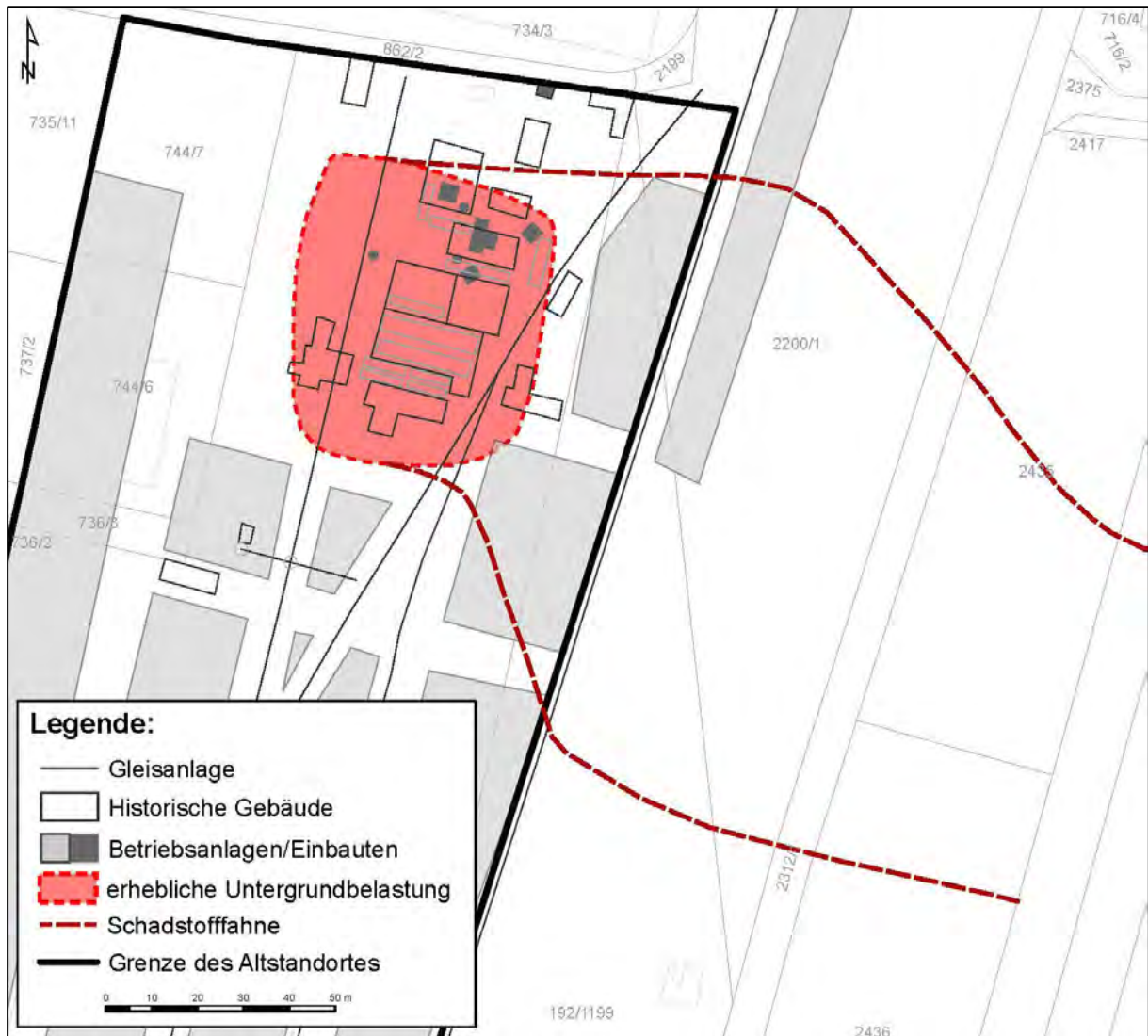
Abb.7: Erheblich verunreinigte Untergrundbereiche und Grundwasser- verunreinigungen
