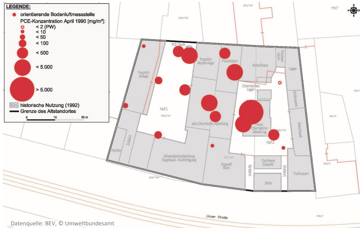
Abb. 6: Verteilung der PCE-Konzentration in der ungesättigten Bodenzone in 0,6 m Tiefe (Messwerte wurde umgerechnet mit 1 ppm = 6,9 mg/m 3 ).
