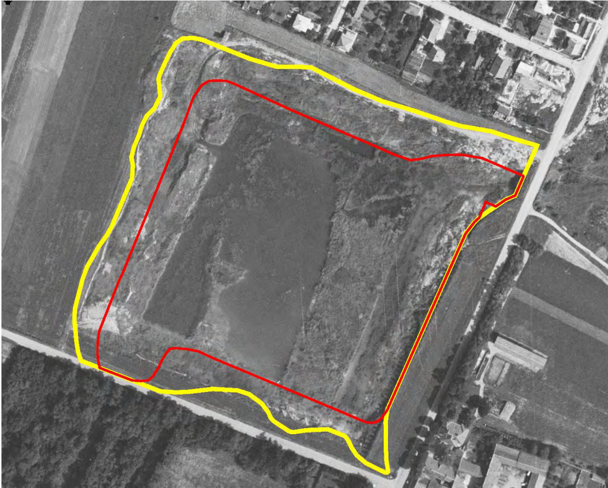
Abb. 3: Luftbild aus dem Jahr 1966 mit Grenze der Altablagerung (gelb) und der Altlast (rot)
