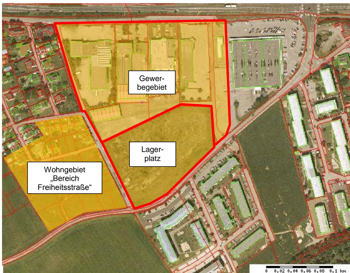
Abb.3: Altablagerung (gelb hinterlegt) und Altlast (rot umrandet) mit den 3 Nutzungsbereichen (Orthofoto 20.7.2007)
