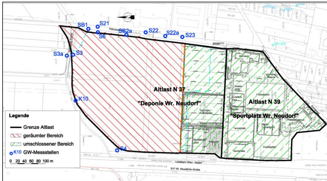
Abbildung 2: geräumter Teil der Altlast N 37 „Deponie Wiener Neudorf“ und Lage der Grundwassermessstellen
