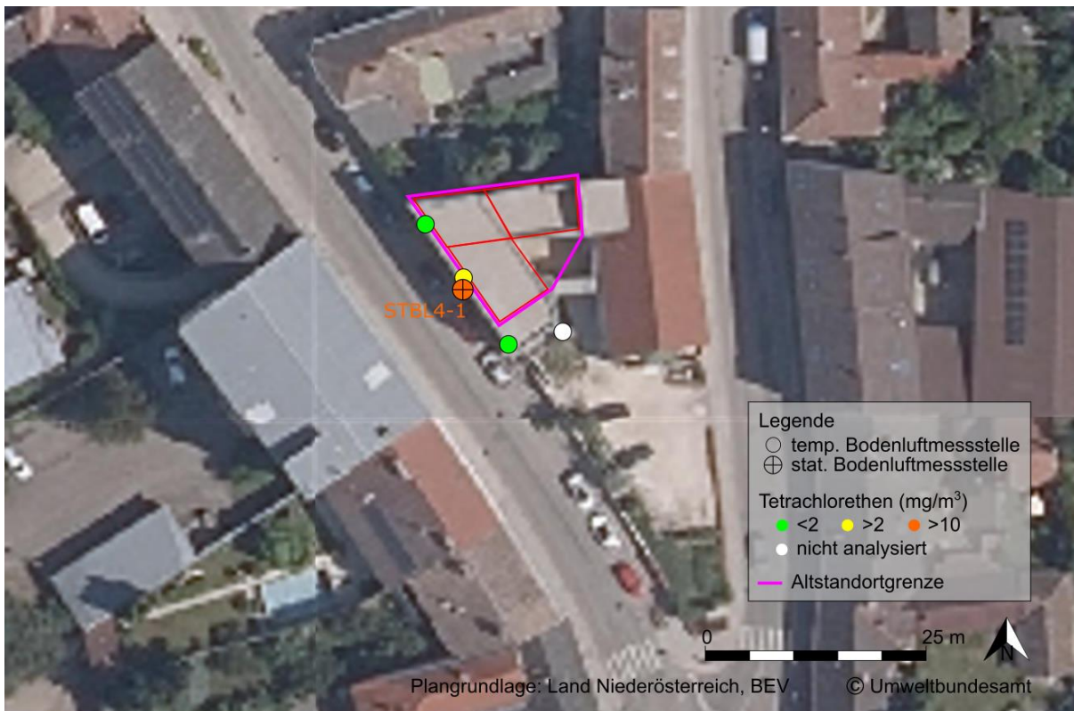
Abb. 4: CKW in temporären und stationären Bodenluftmessstellen
