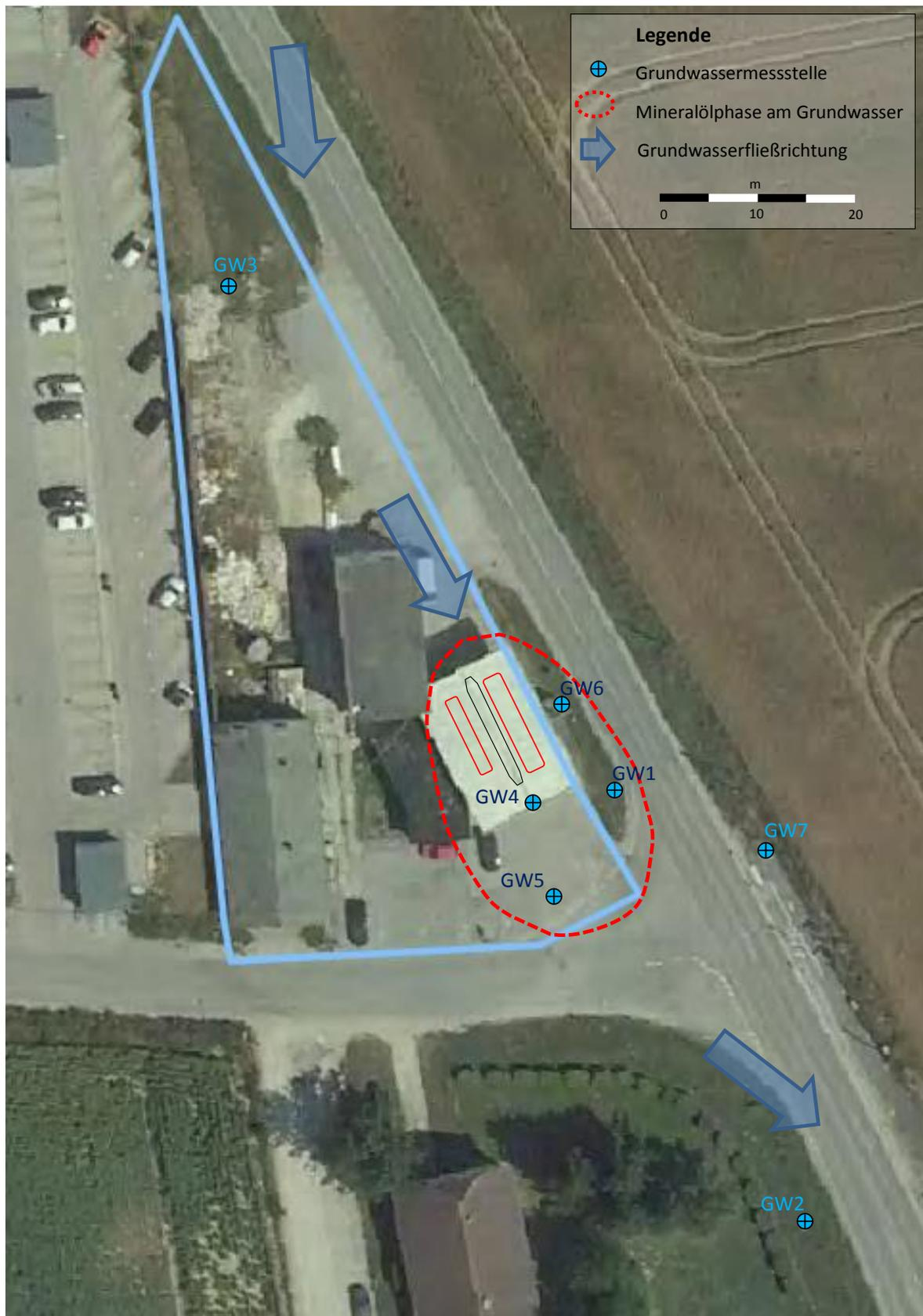
Abb.6: Lage der Grundwassermessstellen, vermutliche Grundwasserströmungsrichtung
