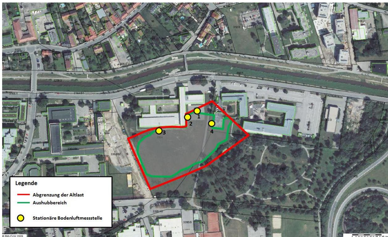
Abbildung 4: Lageskizze des Aushubbereichs und der Deponiegasmessstellen
